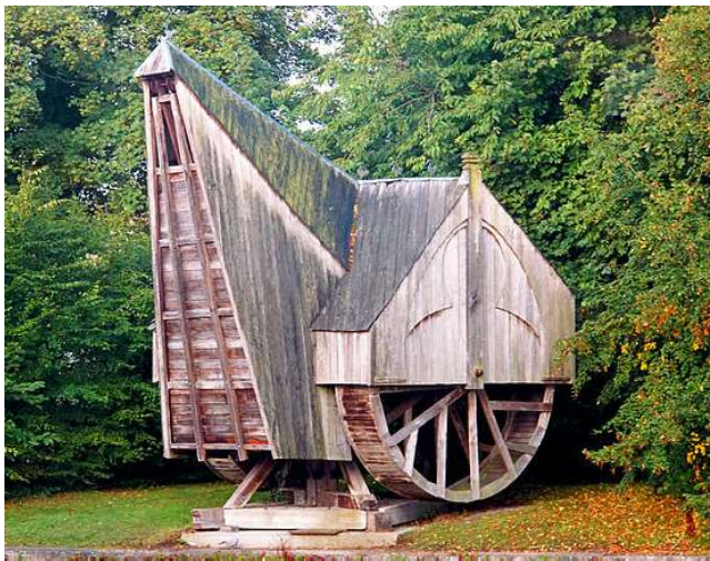
Afb. 14. Links: een replica van een middeleeuwse, houten, mobiele kraan uit Brugge. Rechts: de Nieuwe Kraan van Gdansk in Polen, daterende uit de periode 1442-1444.
